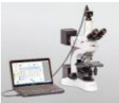
图一：静态颗粒图像分析仪
